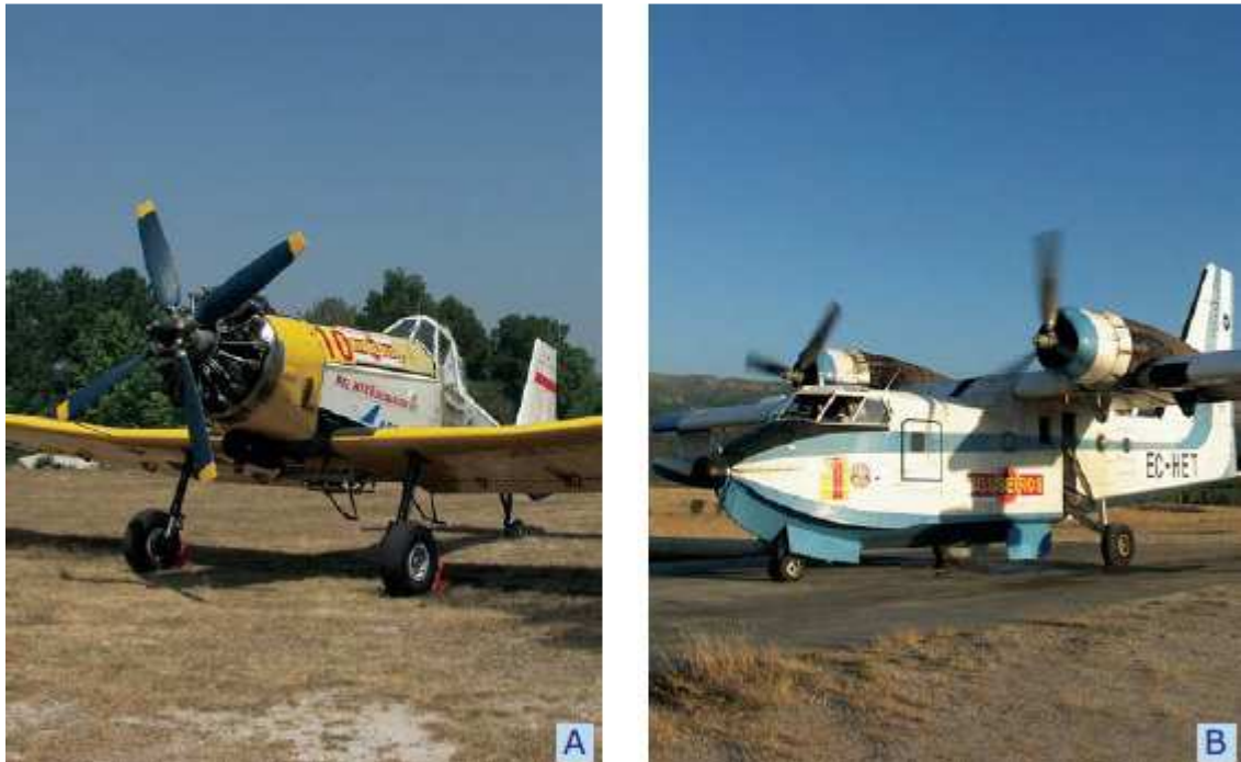
FIGURA 84: Exemplos de aerotanques utilizados no combate a incêndios florestais. A – Aerotank rápido; B – Aerotank pesado.
