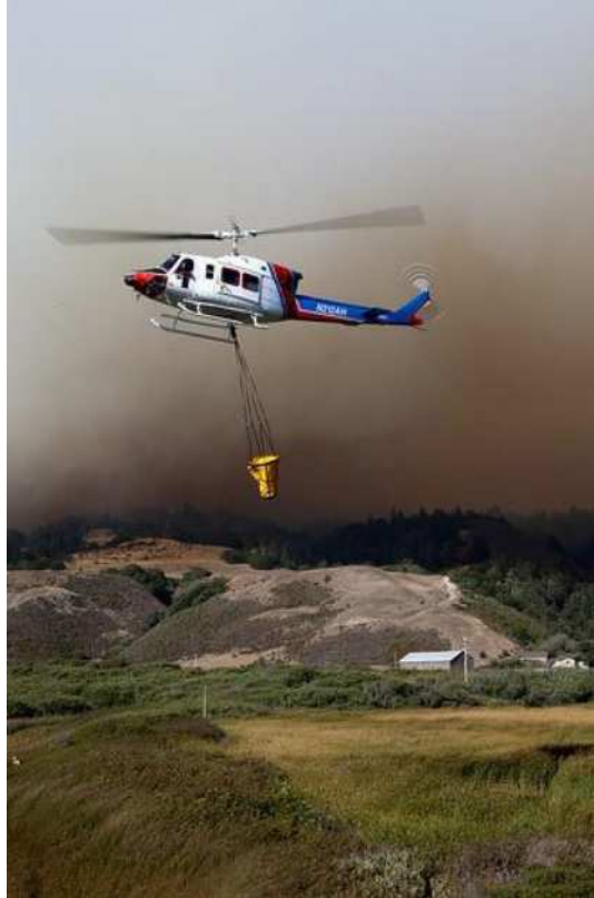
FIGURA 74: Bell 412 em operação.
