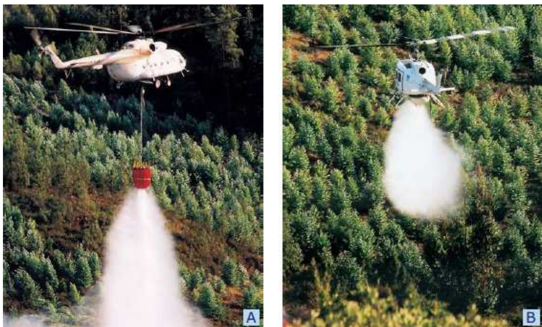
FIGURA 83: Helicópteros utilizados nos incêndios florestais. A – Helicóptero bombardeiro pesado com balde; B – Helicóptero bombardeiro leve com tanque.
