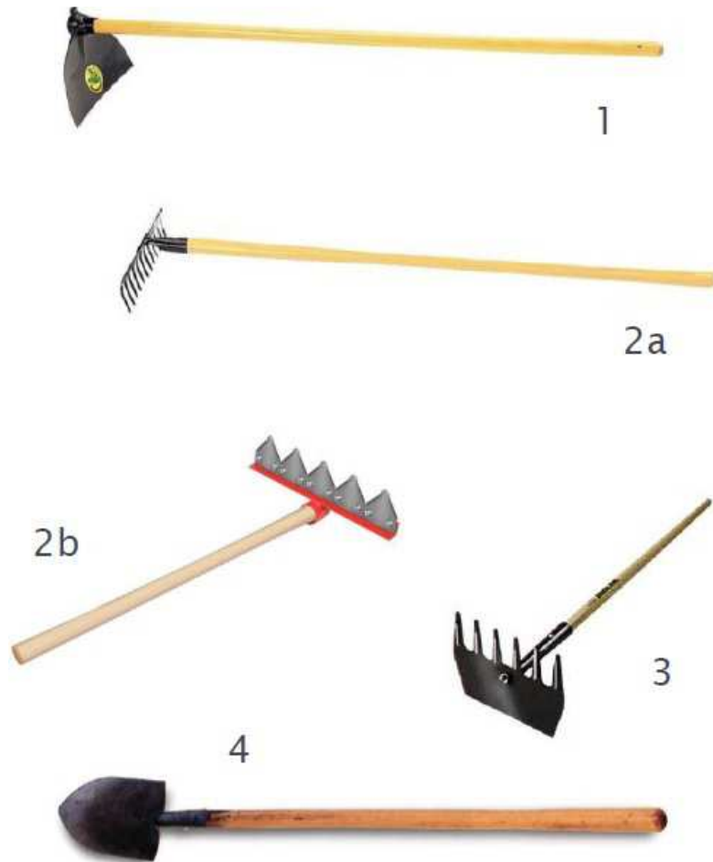
FIGURA 43: Ferramentas de combate a incêndios florestais. 1. Enxada, 2A e 2B Rastelo, 3 McLeod, 4. Pá.
