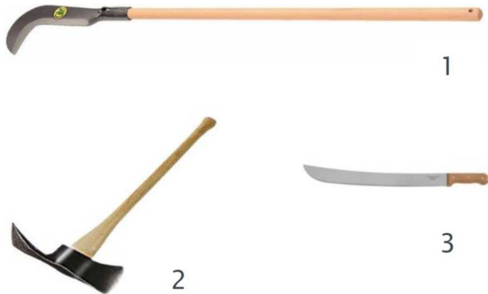
FIGURA 42: Ferramentas de combate a incêndios florestais. 1. Foice, 2. Pulaski, 3. Facão.
