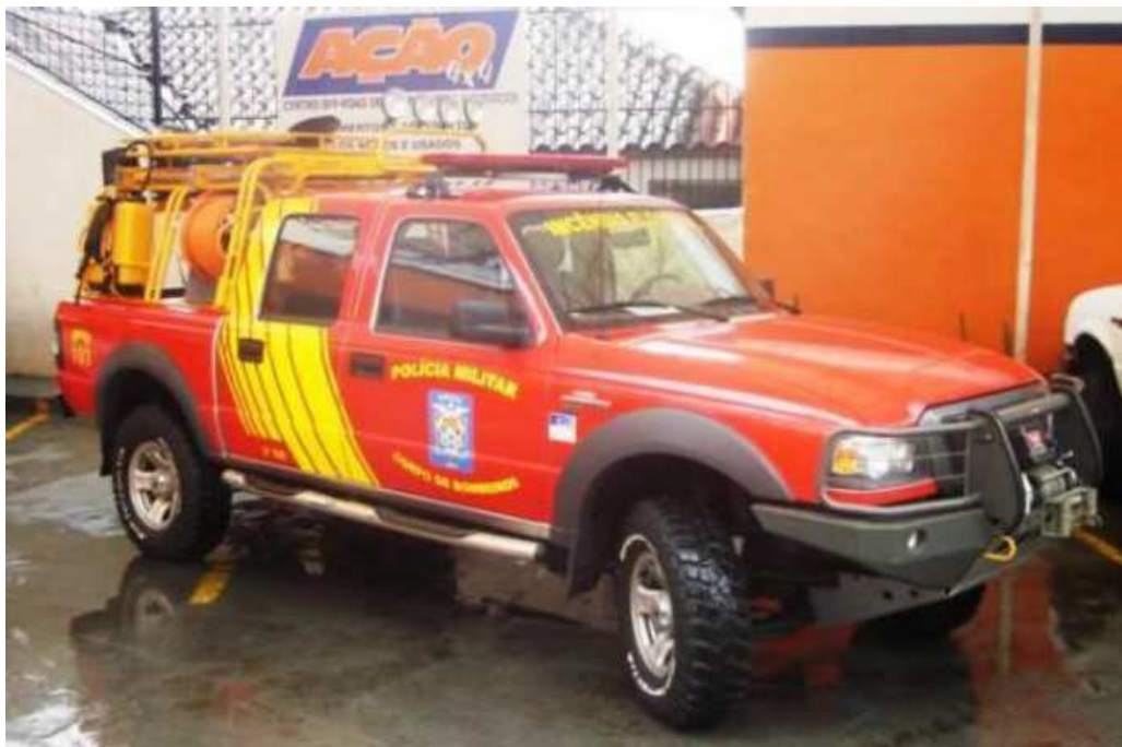
FIGURA 76: Viatura preparada para combate a incêndios florestais, com tanque fixo para 700 litros de água e kit de ferramentas (Corpo de Bombeiros de Londrina/PR).
