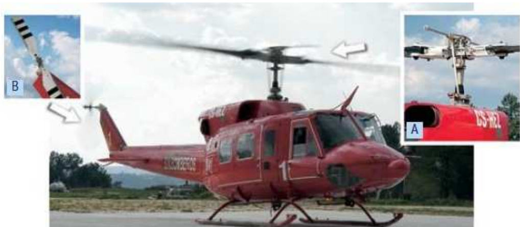
FIGURA 160: Rotores de um helicóptero. A - Rotor Principal, B - Rotor de cauda.
